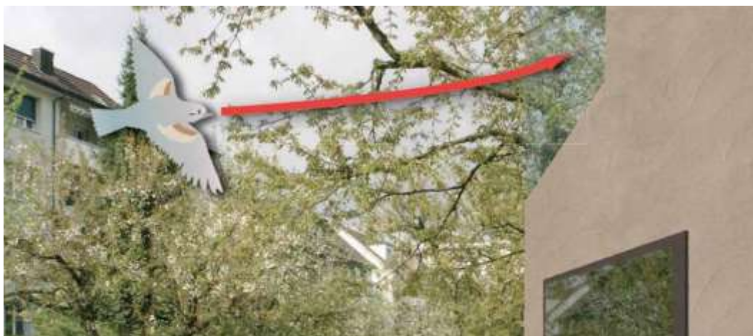
Figura 4-5: Dinamica di collisione di un uccello contro pareti angolari trasparenti (Fonte: Schmid H., Doppler W., Heynen D., Rössler M., 2013)
